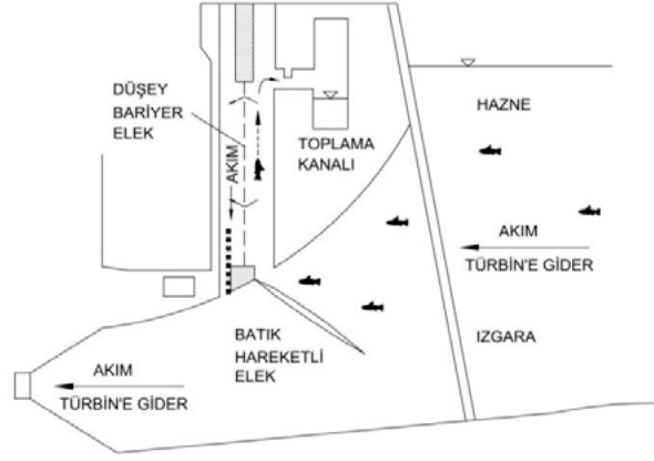
Şekil 3 Su Alma Ağzı (Türbin) Yapısında Elek.
