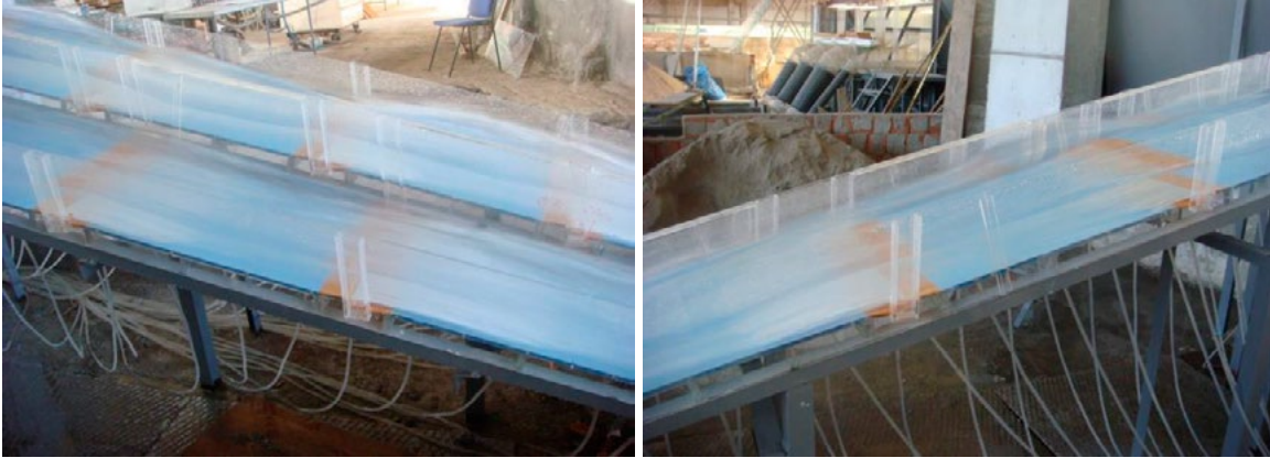
Şekil 5. Kanal-I ve II'nin 1. ve 2. havalandırıcılarının yandan görünüşü ( Q=Q_{PMF} )
