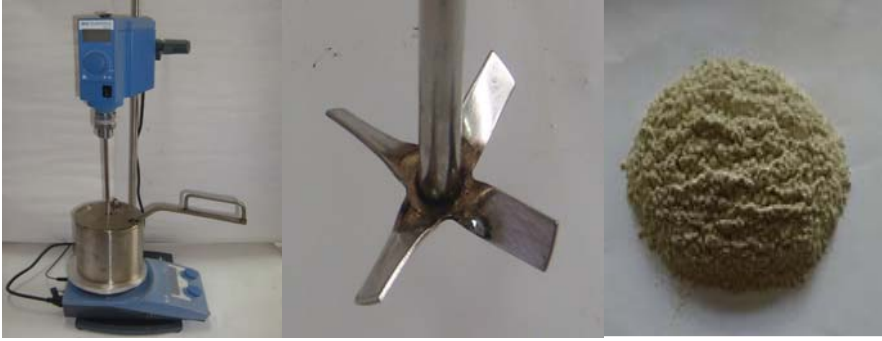
Şekil 1 Modifiye bitüm karıştırma cihazı ve kullanılan bentonit.
